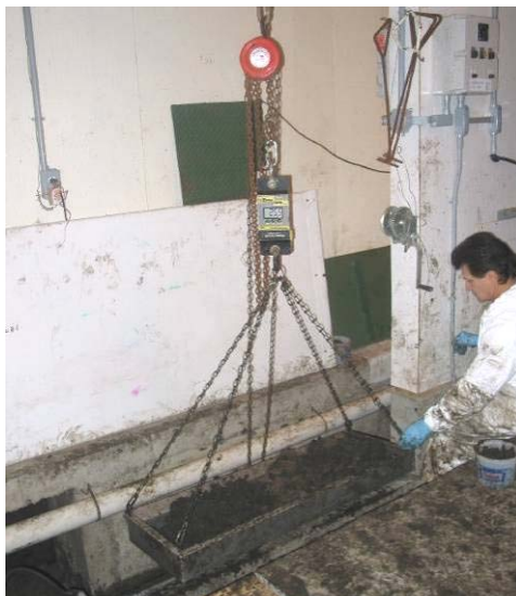
Figure 10 : Bac de collecte de la fraction solide
